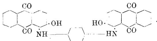
3 g 1-*p*-Amidoanilido-2-oxy-anthrachinon, 4 g Chloroxyanthrachinon und 150 ccm Nitrobenzol wurden mit etwas Kupferpulver 30 Stunden zum Sieden erhitzt. Wurde heiß filtriert und auf die Hälfte konzentriert, so schied sich beim Erkalten das Kondensationsprodukt als schwarzbraunes Pulver ab, das, abfiltriert und mit heißem Alkohol ausgewaschen, nach dem Trocknen folgende Analysenzahlen ergab:
