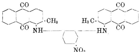
2 g 1-*p*-Nitro-*o*-chlor-anilido-2-methylantrachinon, 2 g Methylamidoanthrachinon; 10 g Naphthalin, 0.5 g Kaliumcarbonat und etwas Kupferpulver wurden 16 Stunden im geschlossenen Rohr auf 250° erhitzt. Der Röhreninhalt wurde zuerst mit Alkohol, dann mit Pyridin ausgekocht, hierauf zur Entfernung des Kupfers mit verdünnter Salpetersäure auf dem Wasserbad digeriert, dann filtriert und mit Wasser nachgewaschen. Nach dem Trocknen bei 120° ergab das Produkt folgende Analysenzahlen:
