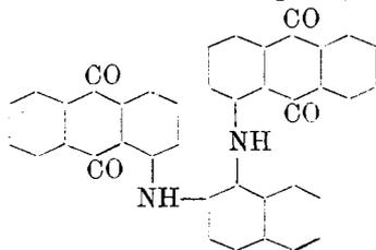
5 g 1-Anthrachinonyl-*o*-naphthylendiamin, 5 g 1-Chloranthrachinon, 250 ccm Nitrobenzol und etwas Kupferpulver wurden 30 Stunden zum Sieden erhitzt, filtriert und mit siedendem Nitrobenzol das Filter nachgewaschen. Das Nitrobenzol wurde hierauf mit Dampf abgeblasen und der Rückstand mehrmals mit Alkohol ausgekocht, um das unveränderte Chloranthrachinon zu entfernen, hierauf filtriert und bei 120° getrocknet. Zur Analyse aus Pyridin umkrystallisiert.
